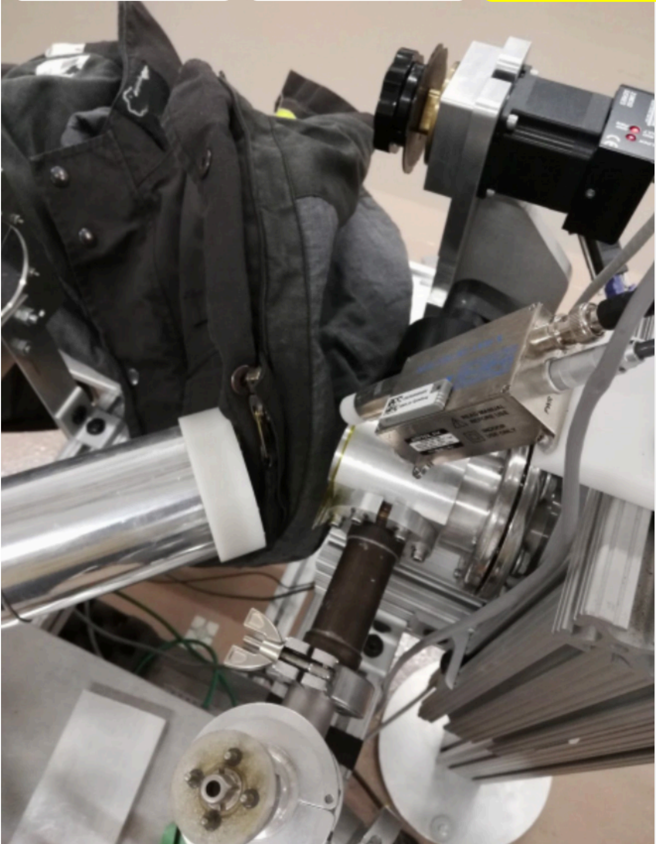
Graham Peaslee analizza un completo anti-fiamma consegnato da IrpiMedia per rilevare la presenza di Pfas sulla superficie esterna e interna della tuta
