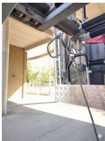
Inserimento connettori in acciaio ai punti di attacco laterali
