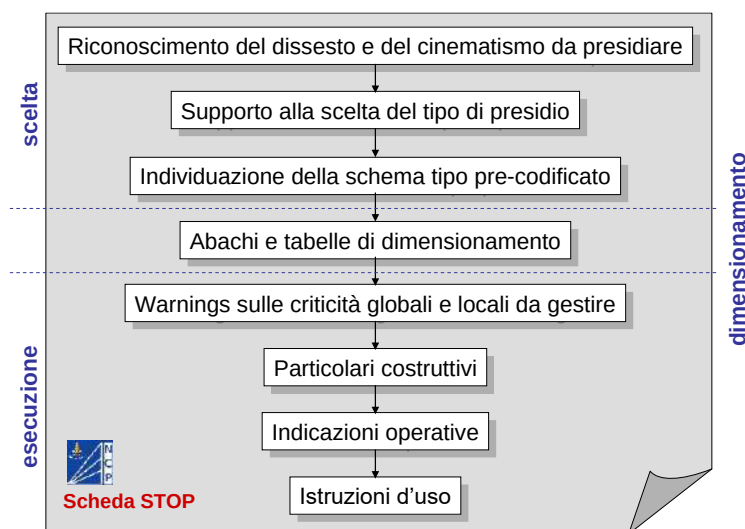
Figura 3.1 Struttura logica delle schede STOP.
